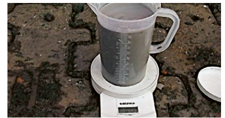
Dichtebestimmung mit einer Haushaltswaage (5 kg) und einem definierten Litergefäß
