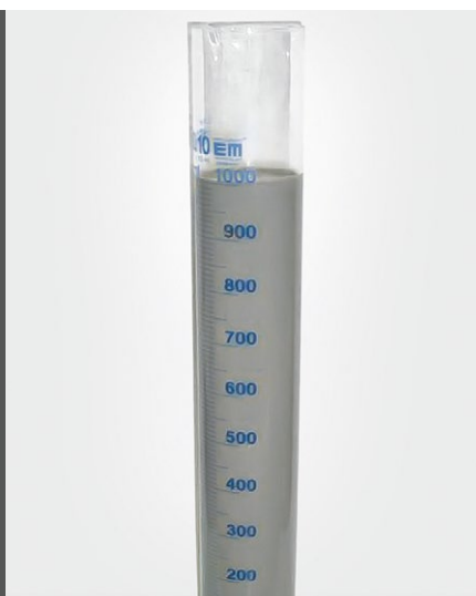
Ermittlung des Wasserabsetzens von ThermoCem PLUS bei W/F-Wert 0,8.
