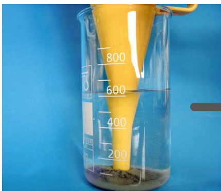
Kontraktorverfahren; homogene Suspension.
