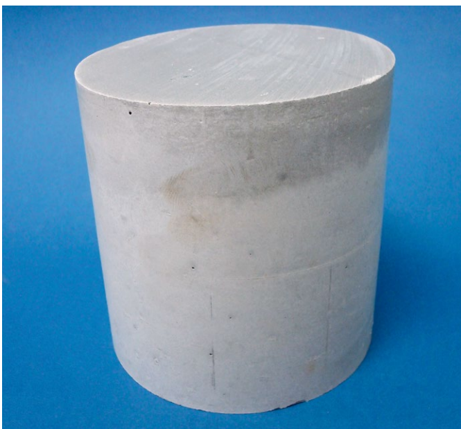
ThermoCem Basic nach 10 Frost-Tau-Zyklen; permanente Wasserlagerung.
