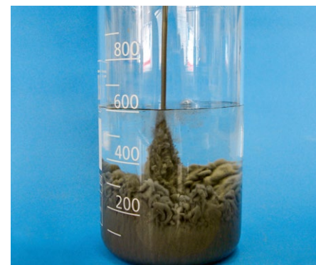
„Fallen“ durch das Wasser = Entmischung.
