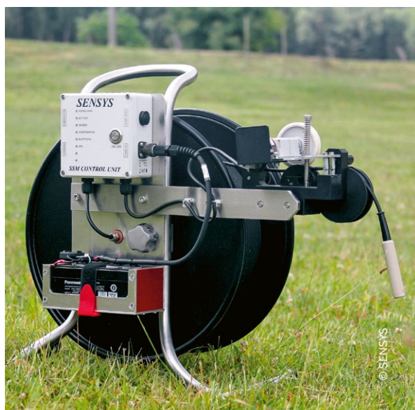
Sensor, Inkrementalgeber, Datenerfassung und Stromversorgung auf Kabeltrommel. SENSYS GmbH
