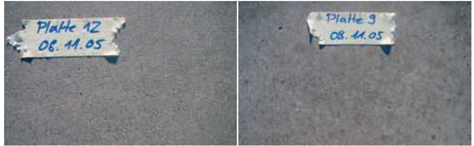
Bild 8: Zustand der Oberfläche: links Flügelglätten mit Hartstoffen; rechts Flügelglätten
