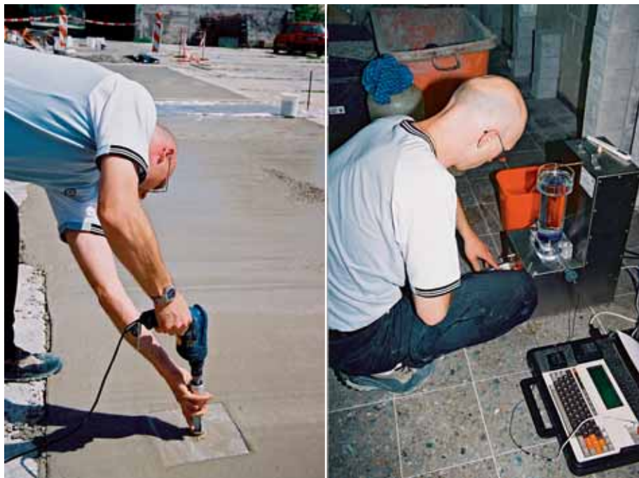
Bild 3: Bestimmung der Luftporenkennwerte am Frischbeton
