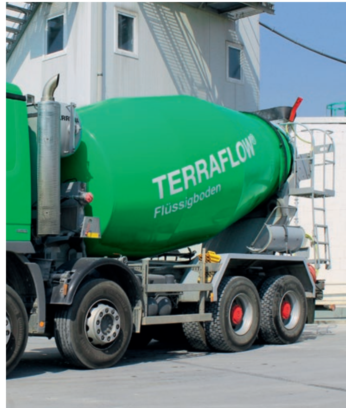
Der fließfähige Verfüllbaustoff wird direkt mit dem Fahrermischer geliefert und kann sofort eingebaut werden.
