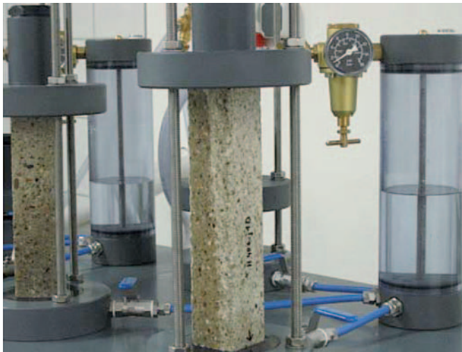
Bild 1. Beaufschlagung der Mörtelprismen mit drückendem Wasser; die Ränder der Prismen wurden mit schmalen Gummidichtungen abgedichtet Fig. 1. Exposure of mortar prisms to water pressure. Narrow rubber seals were used to provide water-tight connections at the prism surfaces
