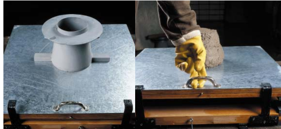
Prüfung Ausbreitmaß beim normalem Beton
