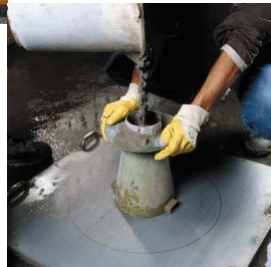
Prüfung Setzfließmaß beim selbstverdichtenden Beton
