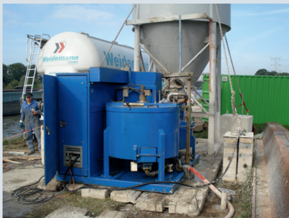
↑ Baustelleneinrichtung zur Herstellung einer Suspension.
